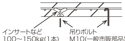
※ 吊りボルトは耐震など必要に応じ、振れ止め用耐震支持部材で補強をしてください。
