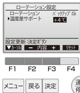
6. [F2][F3] ボタンでサポート運転が動作する「吸込み温度と設定温度の差」を選択する。
