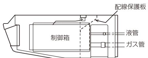
このユニットは後ろ・上の2方向から配管取出しが可能です。上配管をする場合は下図を参考し配管接続してください。
