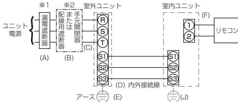
※1 電源には漏電遮断器を取付けてください。
