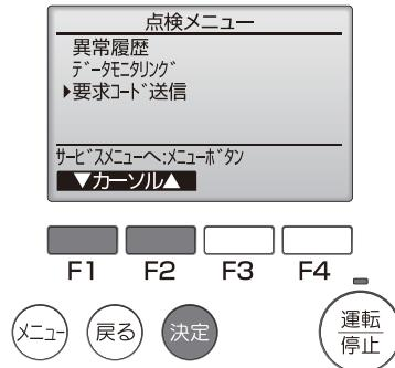
要求コード送信画面に遷移し、MAリモコンが接続された室内ユニット(制御基板)の最小アドレスを検索し、アドレスが表示されます。
