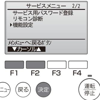
6. [F1][F2] ボタンで室内ユニットの「M-NET アドレス」、「機能設定 No.」、「機能設定値」を選択し、[F3][F4] ボタンで希望の設定に切換える。
