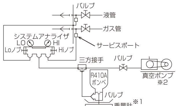
(真空度の上昇幅が130Paより大きい場合、水分が混入しているおそれがあります。もう一度乾燥窒素ガスを充てんし、0.05MPaまで加圧してから再度真空引き乾燥を行ってください。)
