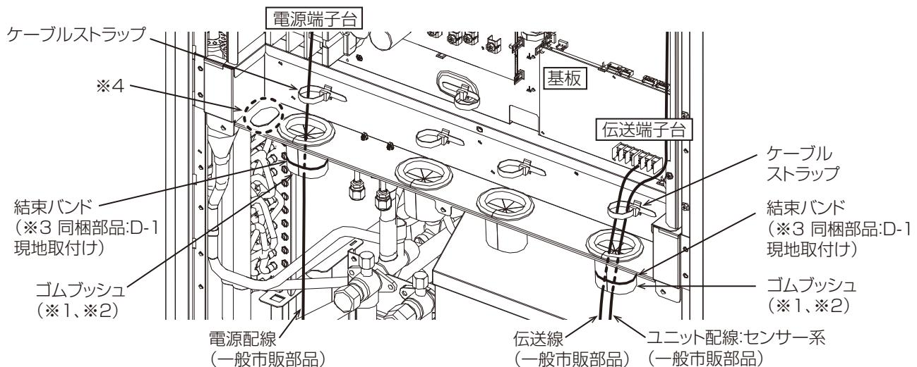
※1 各配線がゴムブッシュ切込み部から飛び出さないようにしてください。
