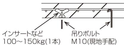
\* いずれの場合にも吊りボルトはM10を使用してください。吊りボルトは現地手配品です。
