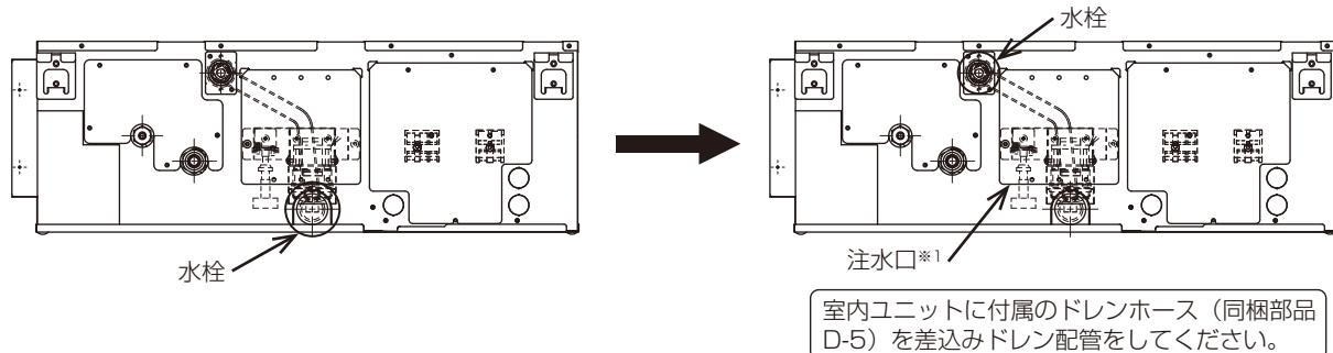
2. 下図のとおり、付属のドレンホース(同梱部品D-5)を使用し、現地配管を接続する。
