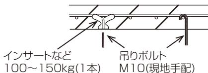
\* 吊りボルトは耐震など必要に応じ、振止め用耐震支持部材で補強をしてください。
