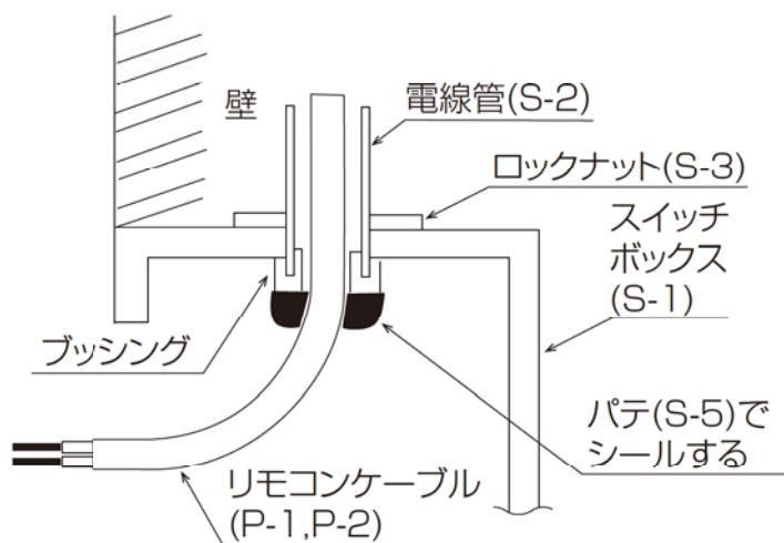
壁面に直接据付ける場合
