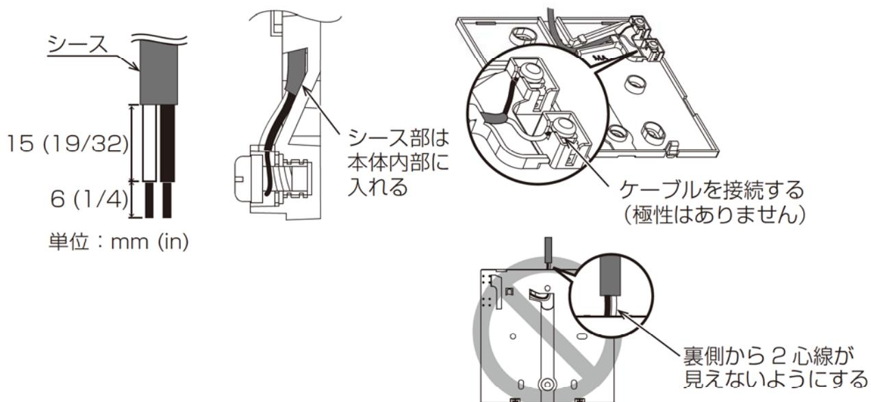
※ シールド線(MVVS)を使用する場合、シールド部が製品内でショートしないようテープなどで絶縁処理を行ってください。
