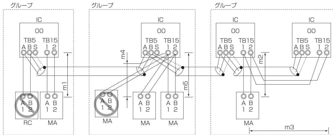
**許容長****MA リモコン配線**総延長 ( $0.3 \sim 1.25\text{mm}^2$ )
