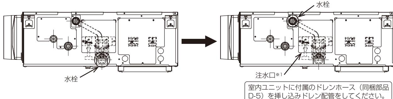
2. 下図のとおり、付属のドレンホース(同梱部品D-5)を使用し、現地配管を接続する。
