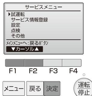
3. 試運転メニューが表示されるので、「試運転操作」を選択し [決定] ボタンを押す。
