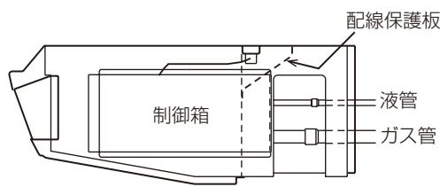
このユニットは後ろ・上の2方向から配管取出しが可能です。上配管をする場合は下図を参照し配管接続してください。
