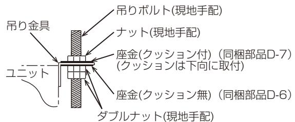
※吊り金具下の締付けナットを締め上げて天井がもち上がる場合は、左図のように固定してください。
