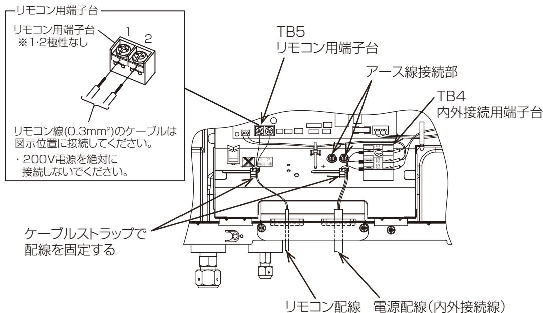
※ 電源を内外別受電方式または室外ユニットより室内ユニットに電源を供給する場合は、別売配線リプレースキットの準備、室内電気品箱内の配線変更（コネクタ付替え）および室外制御基板上ディップスイッチ変更が必要になります。（室外ユニットの据付工事説明書参照）
