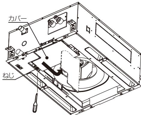
3. 電源配線（内外接続線）およびリモコン配線を行う。
