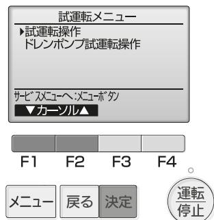
試運転を開始し、試運転操作画面が表示されます。
