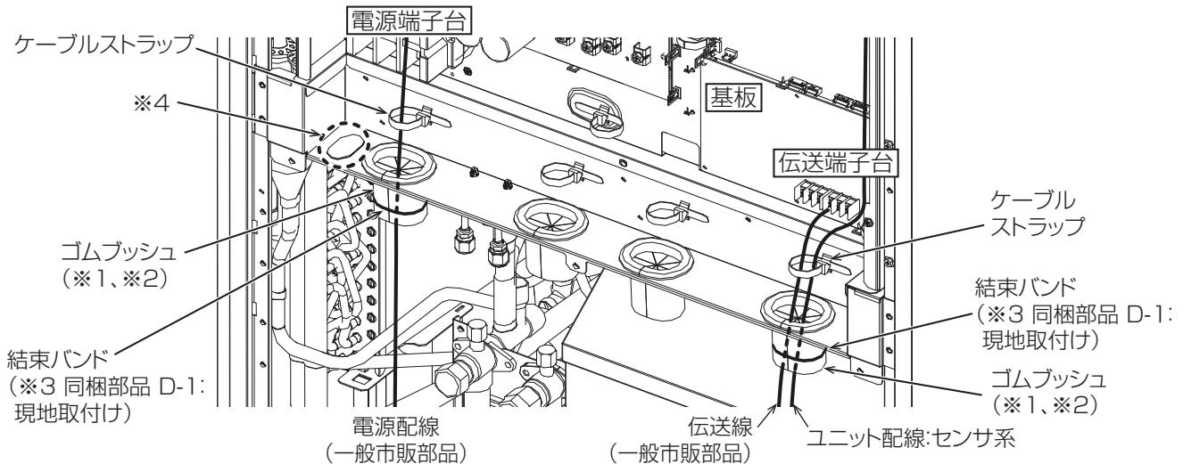
※1 各配線がゴムブッシュ切込み部から飛び出さないようにしてください。
