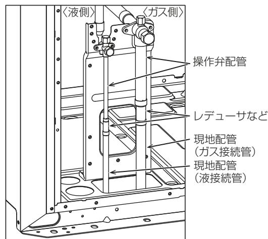
管継手（レデューサなど）を使用し、配管径を合わせて接続してください。
