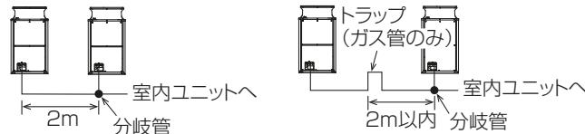
分岐管キットを室外ユニットベースより高い位置で設置する場合は、分岐管キット取付高さを室外ユニットベースから200mm以下としてください。
