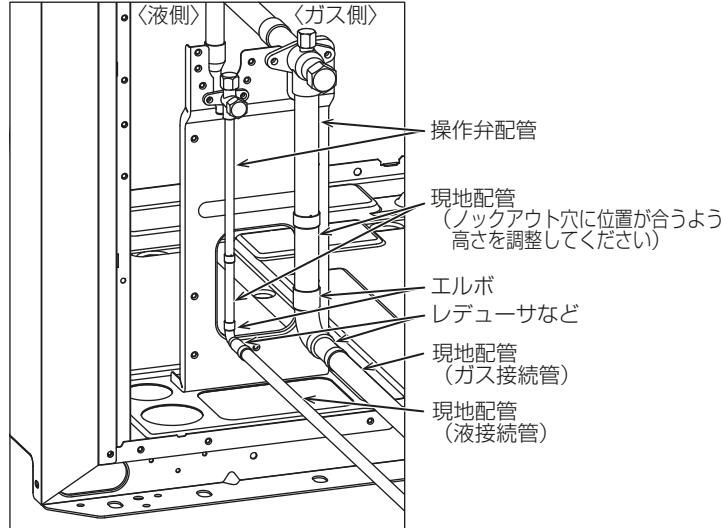
管継手（エルボやレデューサなど）を使用し、配管径を合わせて接続してください。
