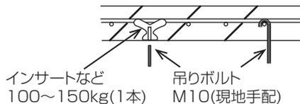
※ 吊りボルトは耐震など必要に応じ、振れ止め用耐震支持部材で補強をしてください。
