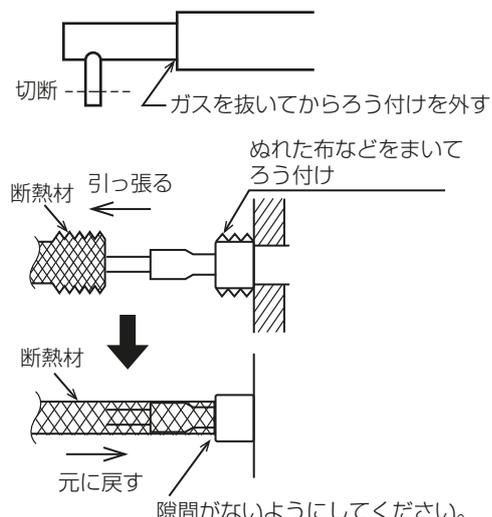
※ 配線保護板の内側には機内配線が通っています。冷媒配管ろう付け時、機内配線および制御箱に火が当たらないようにしてください。
