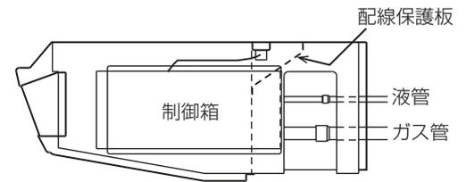
このユニットは後ろ・上の2方向から配管取出しが可能です。上配管をする場合は下図を参照し配管接続してください。
