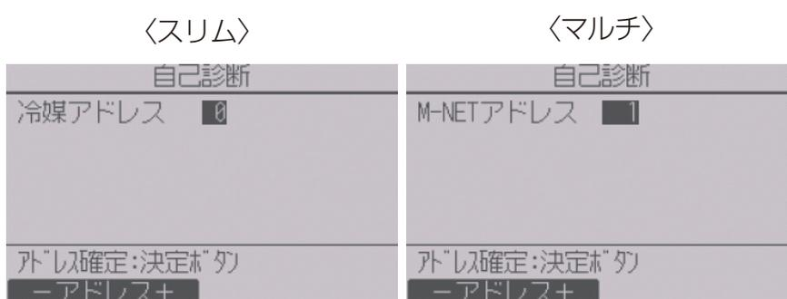
3. [F1][F2] ボタンで冷媒アドレス(スリムの場合)、またはM-NETアドレス(マルチの場合)を設定する。
