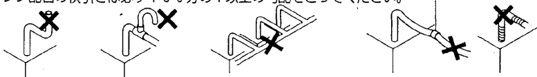
ドレンパイプの再立上げ ドレン配管の通気管 ドレンパイプの横引き上での合流 ドレン配管のトラップ 断熱不良
