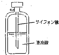
【サイフォン管付ポンベの場合(立てたまま液冷媒を充てんできる)】
