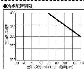
※1. 分流コントローラー～最遠室内ユニット間配管長が40mを超える場合、上図冷媒配管長制限をご参照ください。
