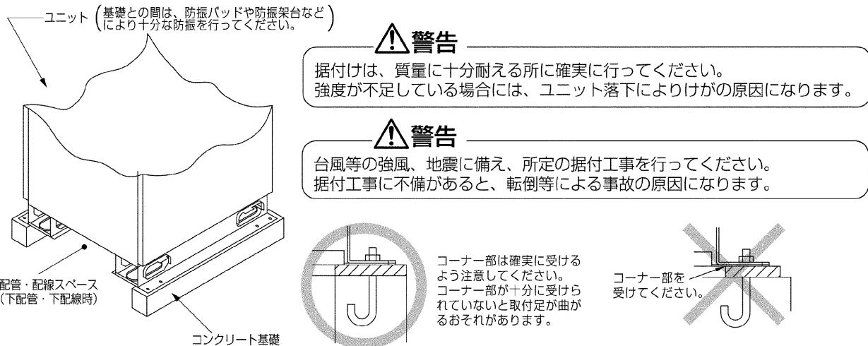
基礎施工に際しましては床面強度、ドレン水処理（運転時にはドレン水がユニット外に流出します）、配管、配線の経路に十分留意してください。
