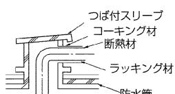
モルタルにてすき間を充てんする場合は、貫通部を鋼板にて被覆し断熱材がへこまないようにしてください。またその部分は不燃性断熱材を使用し、被覆材も不燃性(ビニールテープ巻きはダメ)を使用してください。
