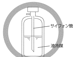
【サイフォン管付きボンベの場合(立てたまま液冷媒を充てんできる)】
