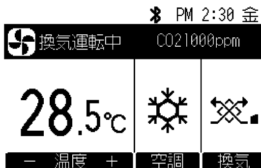
メイン画面(空調換気)
