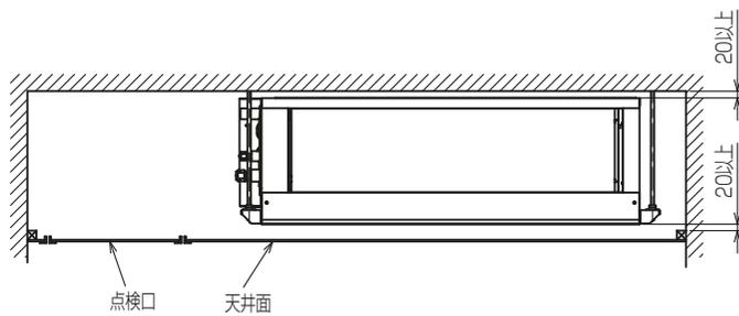
サービスメンテナンスのため指定位置に必ず点検口を設置してください。
