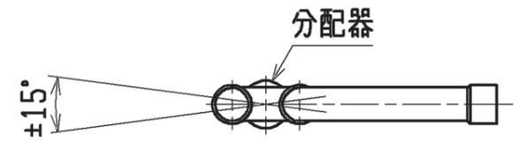
分配器の傾きは水平面に対して $\pm 15^\circ$ 以内
