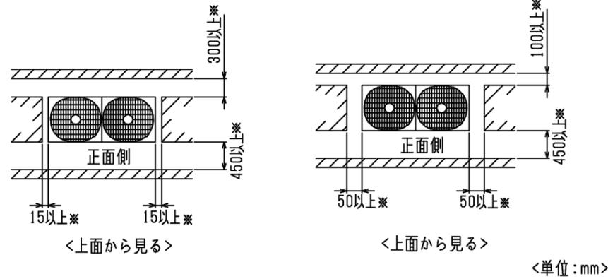
②前後、側面の壁高さ<H>が、下記<壁高さ制約>を超える場合
