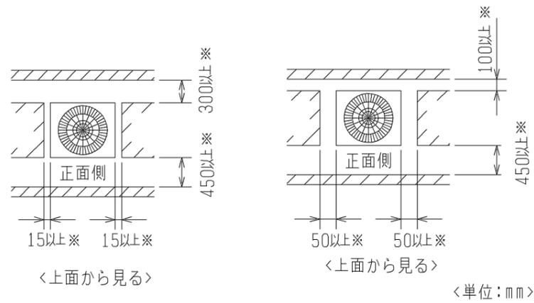
②前後、側面の壁高さ<H>が、下記<壁高さ制約>を超える場合
