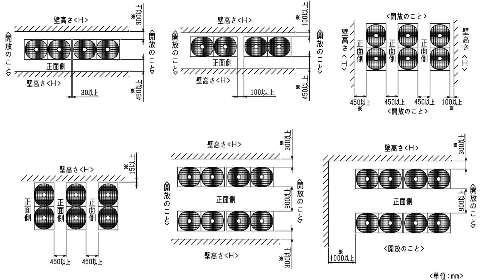
⑤ 室外ユニットの設置においては、季節風やビル風の影響によるショートサイクルを考慮してください。特に、現地設置状況によって、記載された『据付サービススペース』以上のスペースまたは建築工事等での対策が必要になる場合がありますので必要に応じて気流解析等を実施し、製品の運転温度範囲を逸脱しないことを事前に確認してください。
