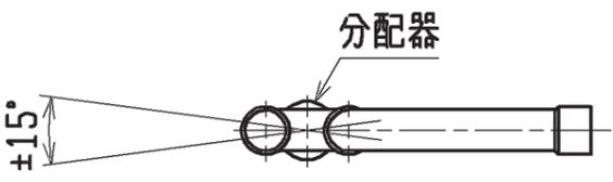
分配器の傾きは水平面に対して $\pm 15^\circ$ 以内
