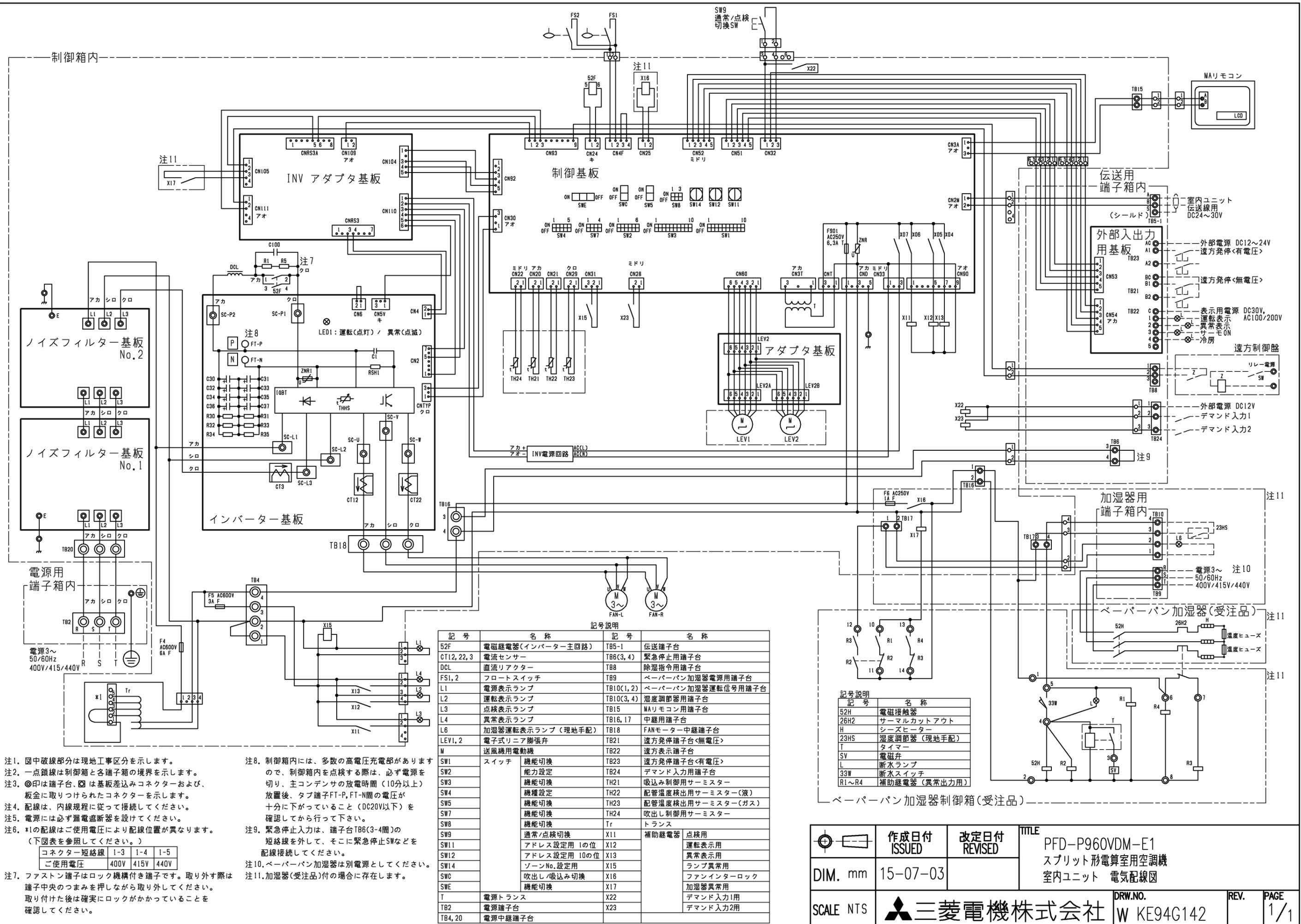
注1. 図中破線部分は現地工事区分を示します。
