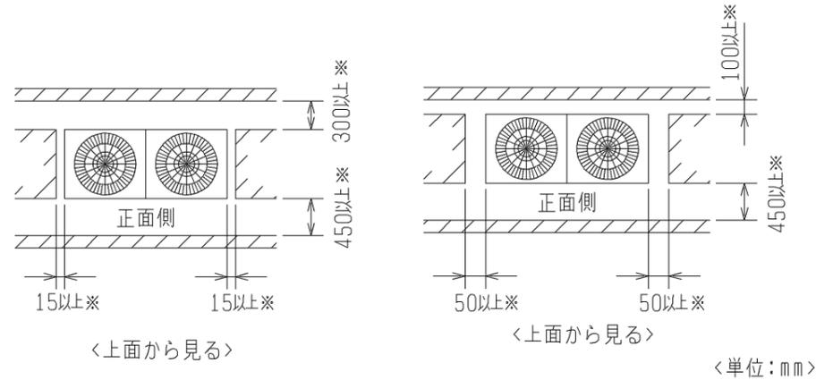
② 前後、側面の壁高さ<H>が、下記<壁高さ制約>を超える場合
