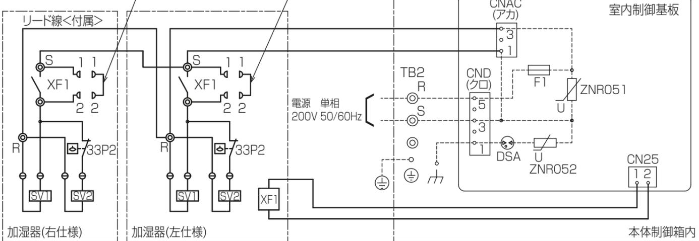
※右仕様の加湿器の運転信号と電源線は加湿器に付属のリード線を左仕様の加湿器に接続し、供給してください。
