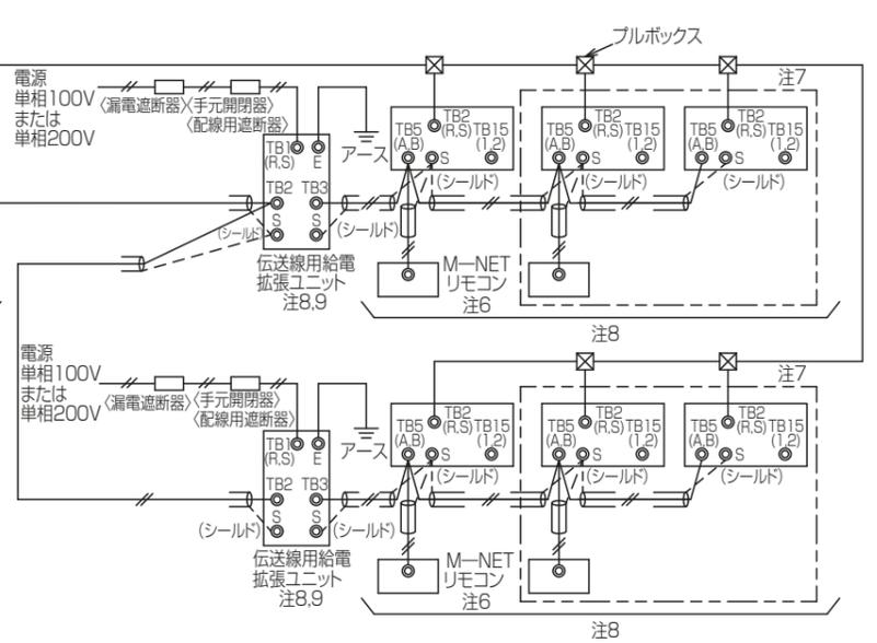
\*接続室内ユニットの種類により電源仕様、開閉器、遮断器仕様が異なりますので設計工事マニュアルをご参照ください。
