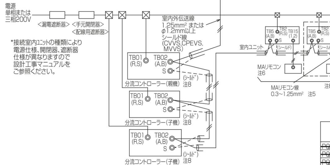
\*接続室内ユニットの種類により電源仕様、開閉器、遮断器仕様が異なりますので設計工事マニュアルをご参照ください。
