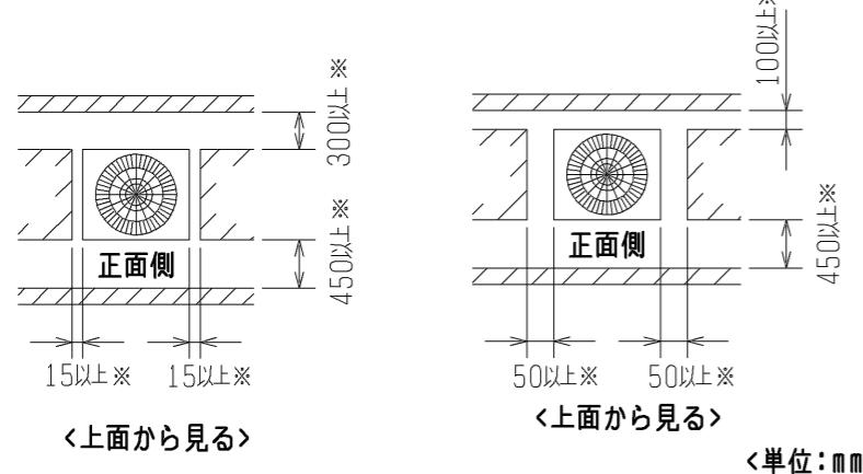
②前後、側面の壁高さ<H>が、下記<壁高さ制約>を超える場合
