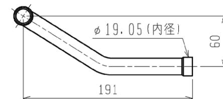
注1. 高圧分岐管の取付姿勢は下図を参照して下さい。
