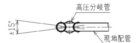
高圧分岐管の傾きは地面に対して±15°以内
