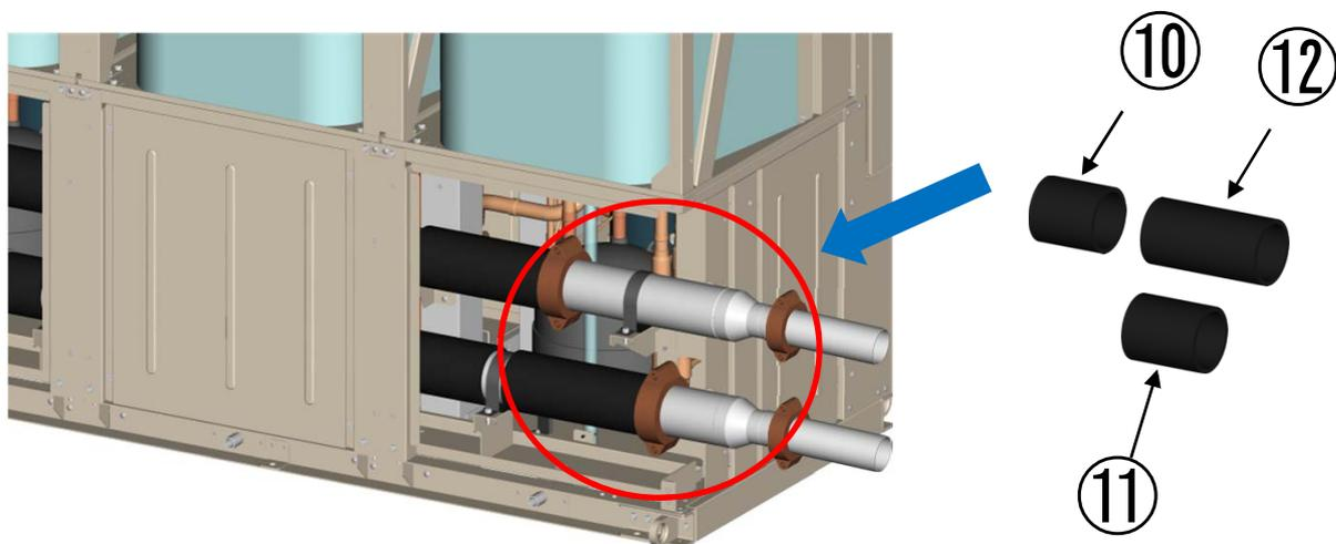
※左側面接続時は⑫を切取り、長さを合わせて取付ください(256mm→208mm)。
