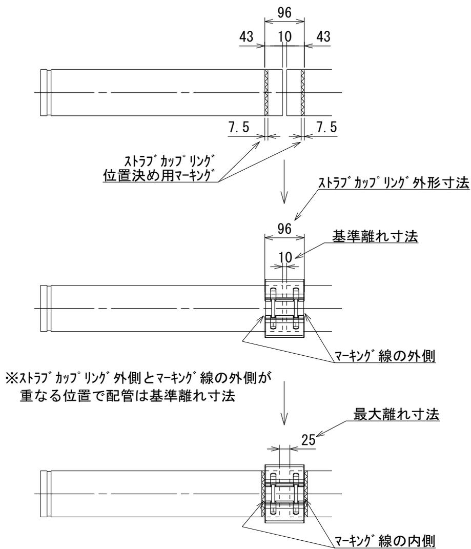
※ストラブカップリング 取付後、ストラブカップリングがマーキング巾線の範囲にあることを確認下さい。
