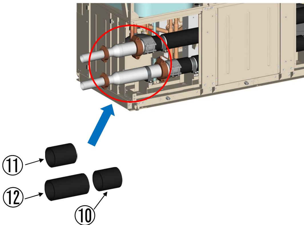
※右側面接続時は⑩を切取り、長さを合わせて取付ください(140mm→91mm)。
