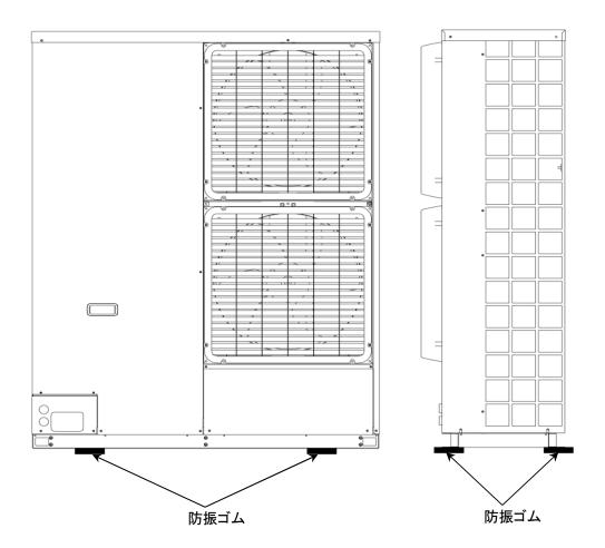
4. 測定位置:ユニット正面より1mのコンクリート地面上
