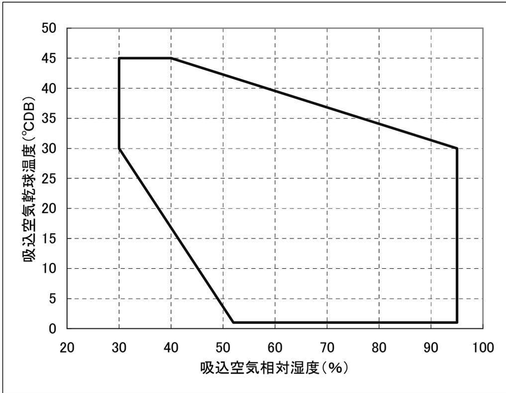
※吸込空気温度が35°C以上で常時使用する場合は強風で使用してください。
