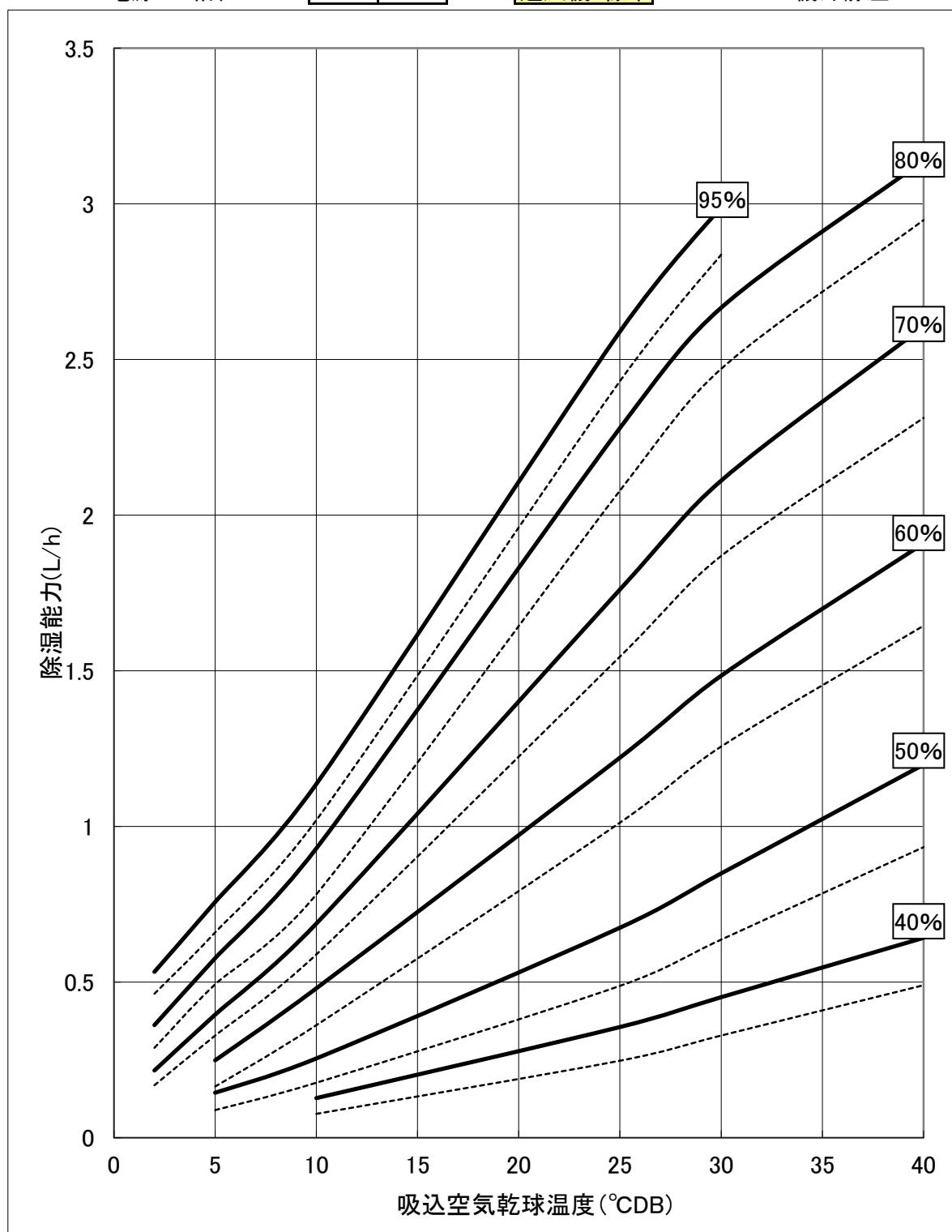
※1. 吸込空気温度が約20°C以下になると自動的に除霜運転を行うため除湿能力が低下する場合があります。
