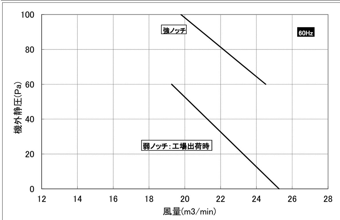
※1. 機外静圧が60Pa以上の場合は、付属の風量切替コネクタを取り付けて下さい。
