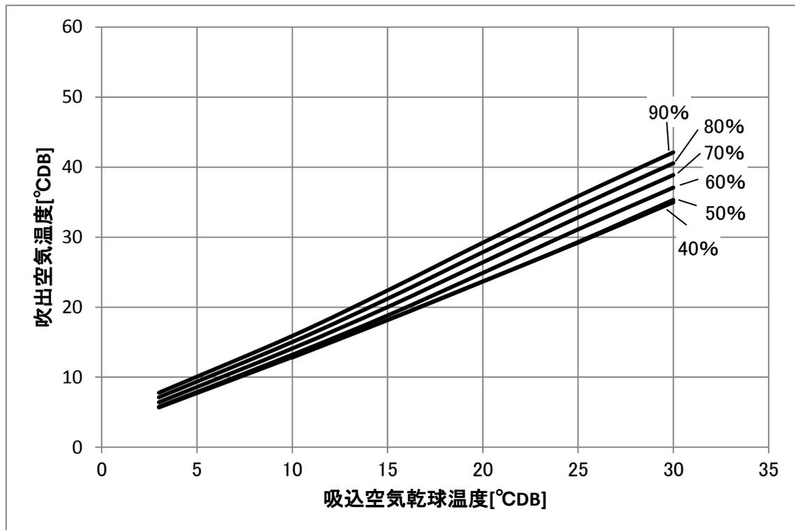
DEH-SP3A加熱能力線図(50Hz)
