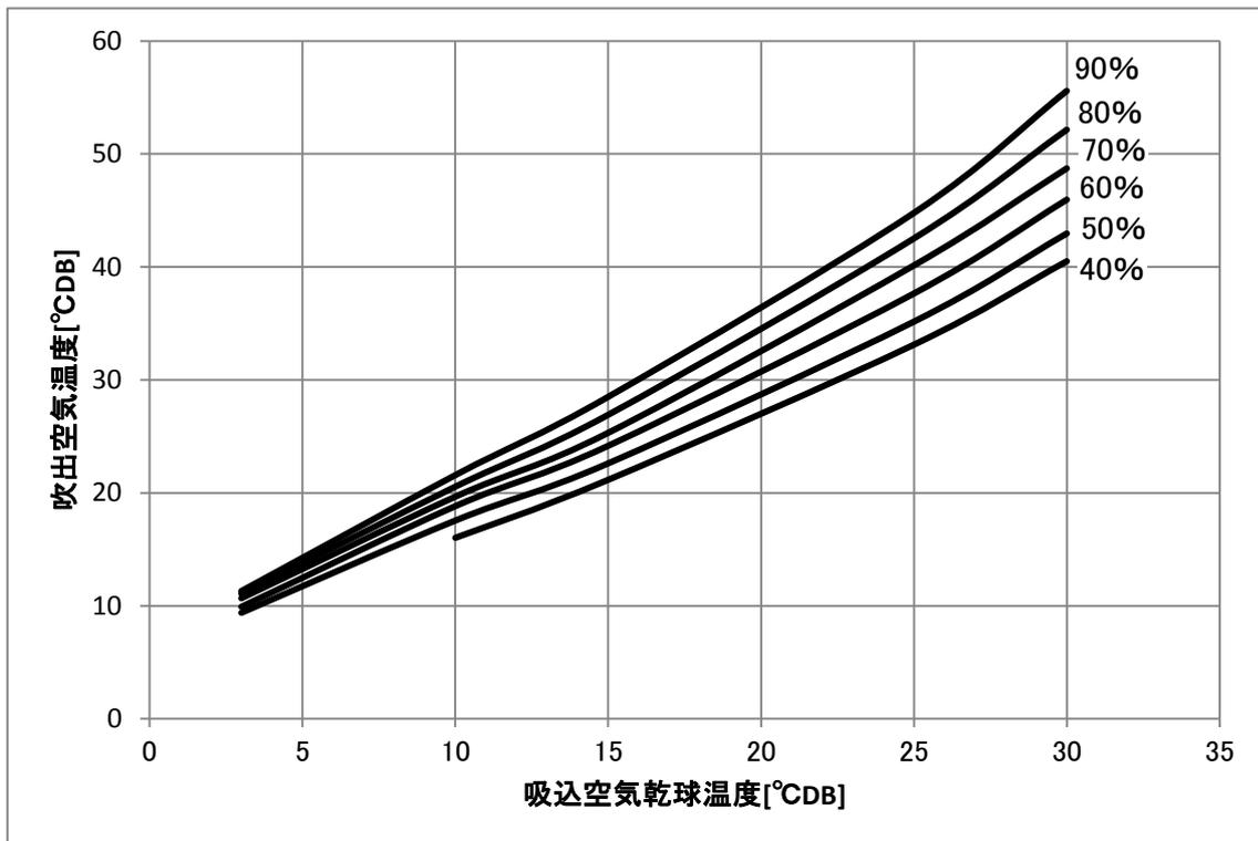
DEH-SP3A加熱能力線図(50Hz)
