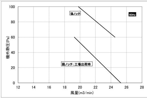
※1. 機外静圧が60Pa以上の場合は、付属の風量切替コネクタを取り付けて下さい。 (弱ノッチ→強ノッチへ切替わります)
