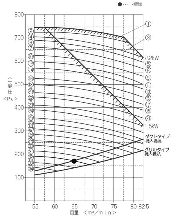
標準点は、モータープーリー径(可変プーリー)を $\phi$ 132.6(出荷時は $\phi$ 116.7)に 調整した値を示します。
