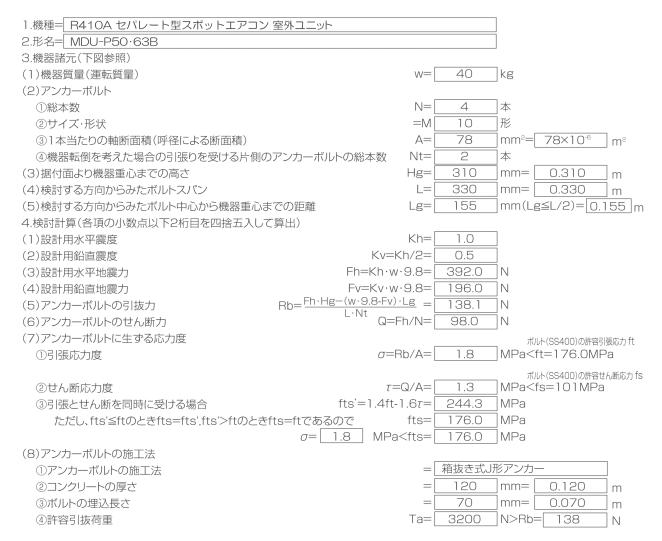
以上の検討結果によりアンカーボルトは十分なる強度を有する。
