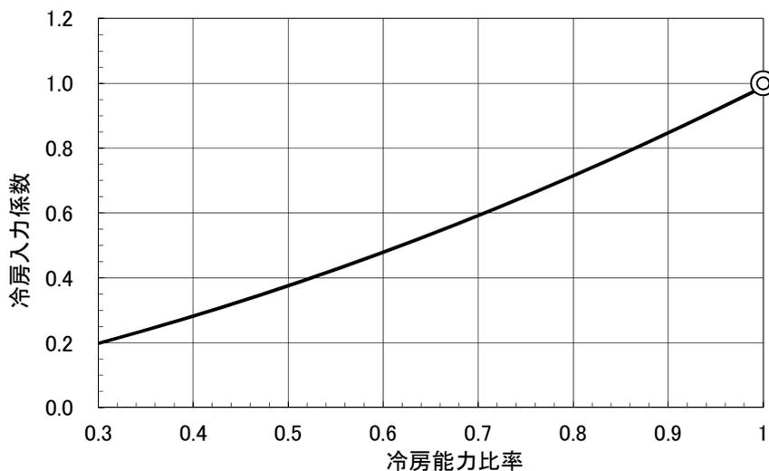
※上記線図は、JIS標準条件、室内風量：400m<sup>3</sup>/min、460m<sup>3</sup>/minのときのものです。
