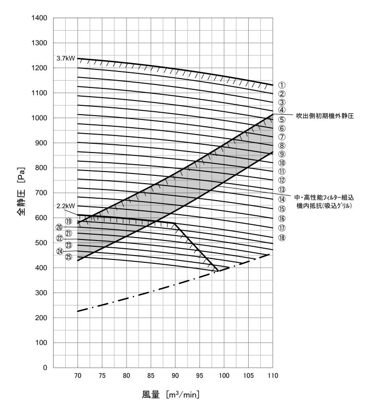
①~⑤は静風圧設定表の設定No.を示します。 標準仕様の静風圧部品選定表を参照ください。 機内抵抗線より上側の組合せNo.を選定ください。 吹出側機外静圧は150Pa以下としてください。( ■ 部)
