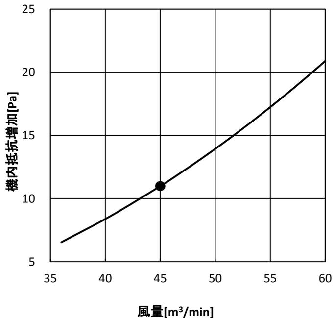
**フィードンフィルター圧損線図**
