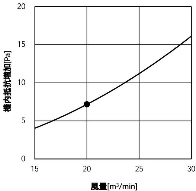
補助電気ヒーター 機内抵抗線図
