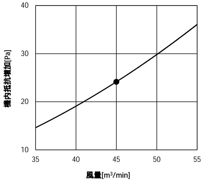
再熱用電気ヒーター 機内抵抗線図
