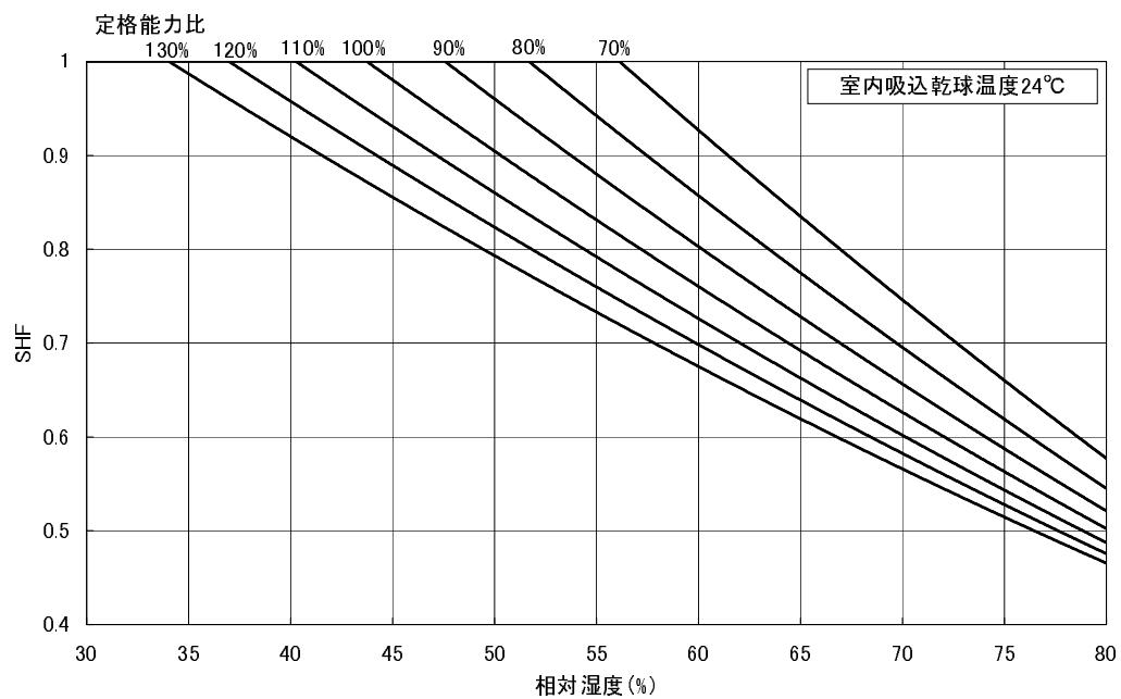
※使用温度範囲は、室内側吸込湿球温度:15~24°C、室外側吸込乾球温度:-5~43°Cです。
