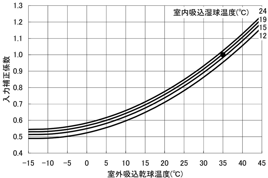
※補正線図は圧縮機最大運転時を表します。
