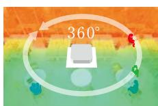
室内を12エリアに分割し、各エリアの床温に加えて、人のいる位置や人数も検出。人の感じ方を考慮した「体感温度制御」によって、人を中心としたムダのない快適空間を実現します。
