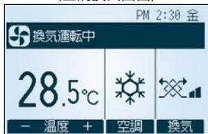
ロスナイ<sup>®</sup>と連動した場合にリモコンへ表示される換気操作画面を使いやすくする設定を新たに搭載。ロスナイ<sup>®</sup>運動時の操作性を高めます。
