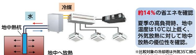
循環水温の例…外気温35℃時、地中熱からの熱源水26℃
