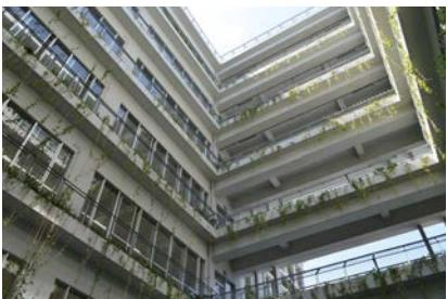
▲外部吹き抜けを利用して良好な採光と通風を確保しています。
