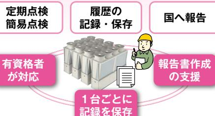
所有者(管理者)には、3ヶ月に1回以上の簡易点検、3年に1回以上の有資格者等による定期点検、履歴の記録・保存、国への報告がフロン排出抑制法で義務付けられています。
