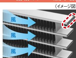
配管形状の扁平化により面積当たりの配管本数を増加させることで、熱交換性能が大幅に向上
