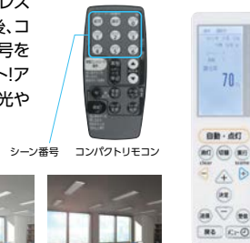
スケジュール制御、初期照度補正⇒双方向ワイヤレスリモコン
