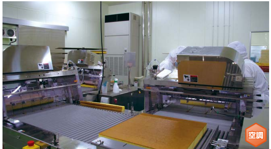
面積の広い製造ラインの空調には、必要な箇所にのみ吹出しダクトを配置
