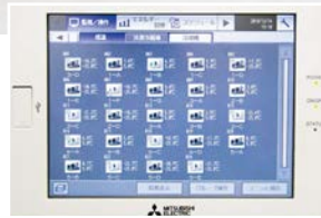
▲AE-200Jによる設備の集中監視・管理を実施。「庫内温度の帳票出力はとても便利」とのこと
