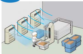
小さい馬力の室内ユニットを3台設置
