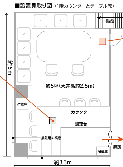
カウンター席のダクト用換気扇。更新後の機種はDCブラシレスモーターを搭載、省エネルギーに優れ、配管圧損に左右されず安定した換気風量を確保できる
